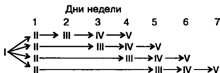
Рис. 5.1. Схема приготовления заквасок трехпересадочным способом (I – БЗ или БП; II – первичная (лабораторная) закваска; III – вторичная (пересадочная) закваска; IV – производственная закваска; V – сыродельная ванна)
